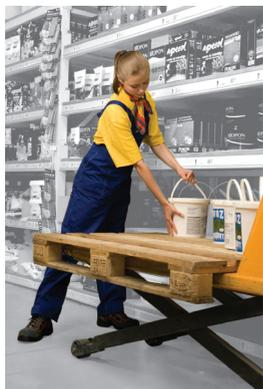
■ El uso de carro con regulación de altura durante la colocación de mercancías sobre anaqueles.
