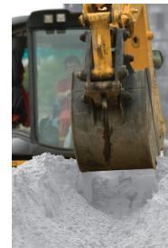
■ La necesidad de trasladar a mano el material de excavación se suprime usando una excavadora, lo que permite al contratista realizar el trabajo más de prisa y acortar significativamente el tiempo necesario para amortizar la inversión.
