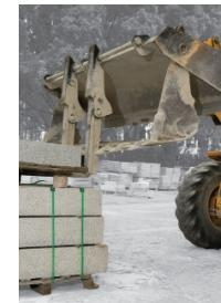
■ Para desplazar materiales de peso significativo o para colocarlas en alturas grandes, sirven de ayuda varios equipos tipo grúas con horquillas.
